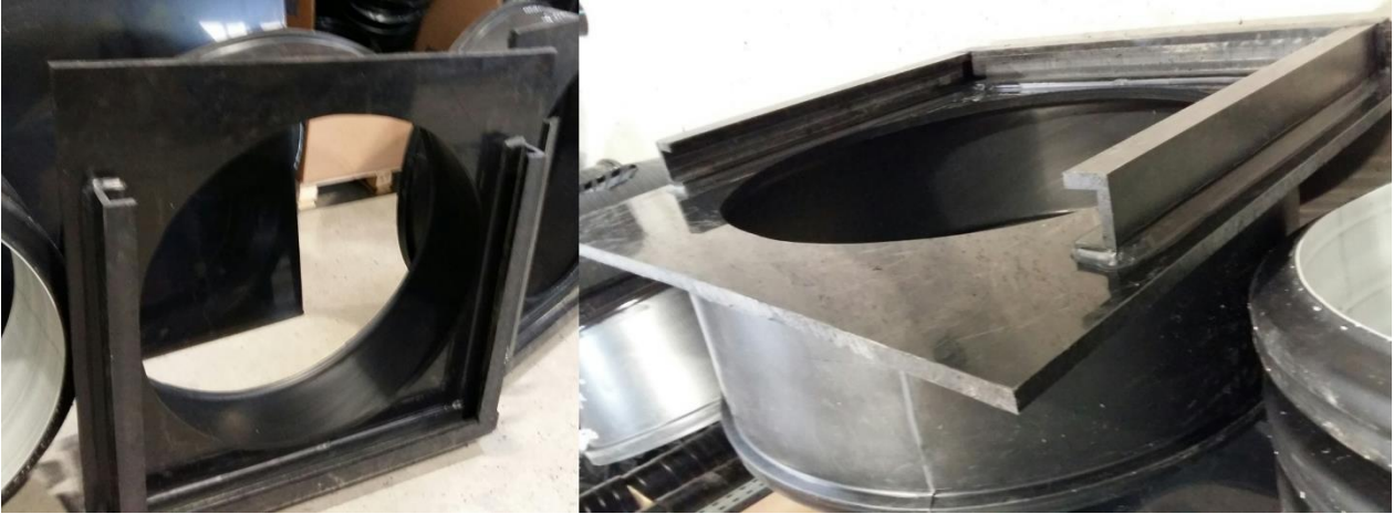
Kuva 5. Säätölankuilla mukautettavan moduulin avulla pohjapadon yläpuolista vesipintaa on mahdollista säätää.
